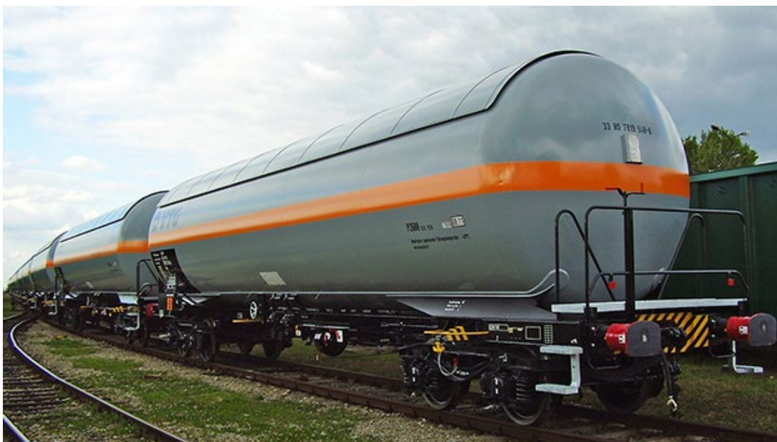
Figuur 1.5 Spoorwagenvoer voor het transport van tot vloeistof verdicht ammoniak (bron: VTG )
